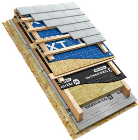
Если монтаж ведется по обрешетке, обрешетка устраивается на смонтированный гидроизоляционный слой, уложенный на сплошной настил.
