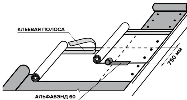
При угле наклона кровли от 12° до 18° ширина перехлеста составляет 750 мм, перехлест фиксируется самоклеящейся односторонней лентой АЛЬФАБЭНД 60.
