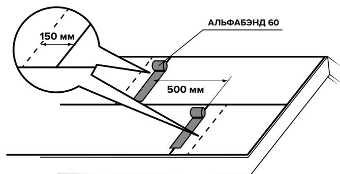
Поперечные нахлесты полимерного ковра АЛЬФА ANDEREP составляют 150 мм. Сверху перехлест проклеивается самоклеящейся односторонней лентой АЛЬФАБЭНД 60. Расстояние между поперечными перехлестами должно быть не менее 500 мм.
