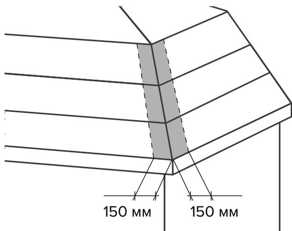
Допускается формирование торцевого элемента из отдельного полотна, уложенного вдоль ребра. При этом нижние полотна подрезаются по линии формирования ребра кровли, а сверху на само ребро, с перехлестом 150 мм на обе стороны ската укладывается элемент подкладочного ковра. Место перехлеста промазывается битумной мастикой ТЕХНОНИКОЛЬ № 23 (Фиксер). Сам элемент, вдоль ската по обе стороны закрепляется ершеными кровельными гвоздями с шагом крепления к основанию 150 мм, выполненным в шахматном порядке.
