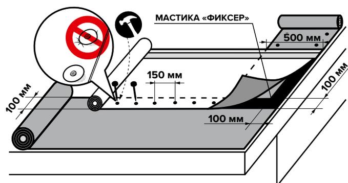
На основной площади кровли АЛЬФА ANDEREP укладывается параллельно карнизному свесу снизу вверх.
