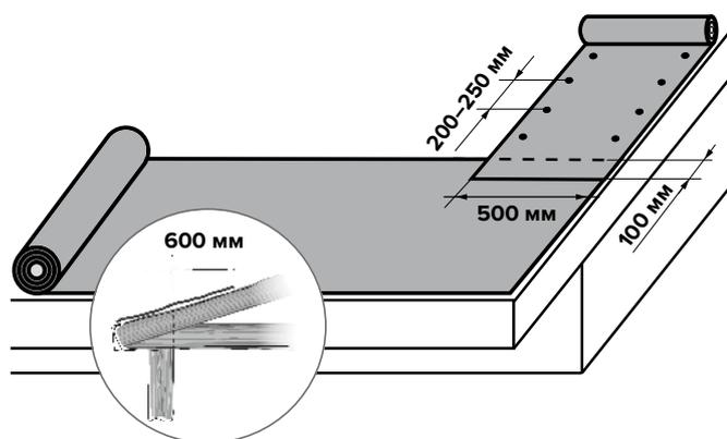
Уложить самоклеящийся подкладочный ковер вдоль карнизного свеса на ширину самого карнизного вылета плюс 600 мм от внутренней плоскости наружной стены внутрь здания. Вдоль фронтового свеса по всей высоте ската уложить самоклеящийся подкладочный ковер шириной 500 мм с перехлестом 100 мм к смонтированному на карнизе самоклеящемуся ковра.
