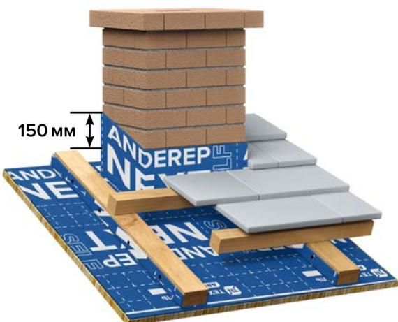
В местах примыканий к выступающим частям здания (стены, дымоходы, вентиляционные трубы и др.), самоклеящийся подкладочный ковер необходимо завести на вертикальную поверхность на высоту не менее 150 мм от верха обрешетки.
