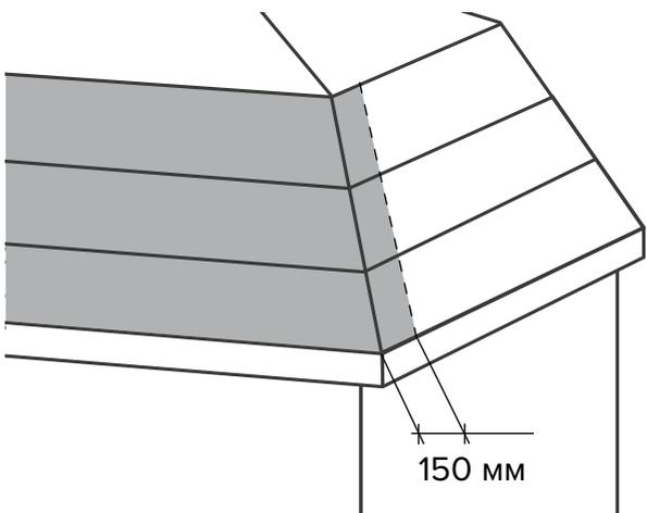
Формирование перехлестов на ребрах кровли происходит по типу формирования поперечного перехлеста. Полотно материала на одном из скатов подрезается по линии формирования ребра. С другого соседнего ската остается выпуск материала, равный 150 мм, который укладывается в перехлест на соседние полотна материала. Сам перехлест промазывается битумной мастикой ТЕХНОНИКОЛЬ № 23 (Фиксер) и дополнительно
