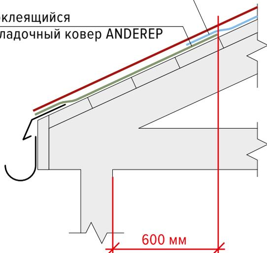
Затем самоклеящийся подкладочный ковер укладывается вдоль карнизного свеса на ширину карнизного вылета, плюс 600 мм от внутренней плоскости стены внутрь здания или сооружения.
