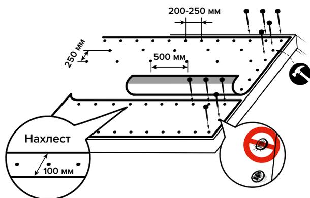
монтаж с помощью кровельных ершених гвоздей
