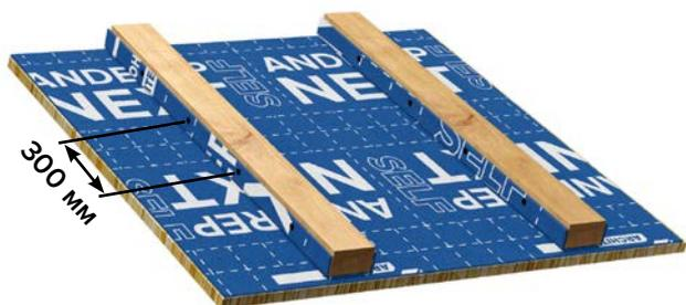
Для защиты древесины от воды, которая может попасть под основание контробрешетки, укладывается дополнительный слой самоклеящегося подкладочного ковра самоклеящимся слоем к контробрешетке.
