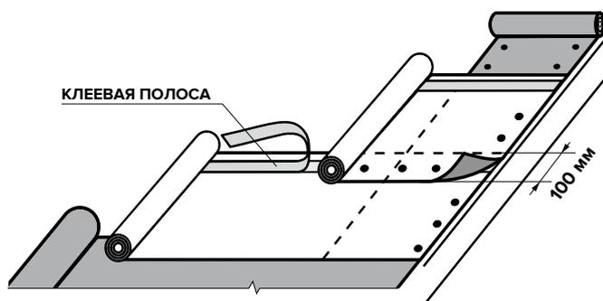
При угле наклона кровли > 18° ширина перехлеста составляет 100 мм.
