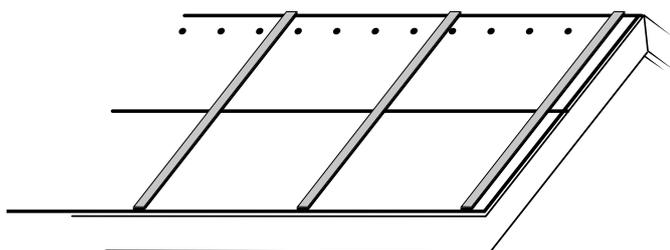
При использовании подкладочного ковра в качестве временной кровли осуществляется механическое крепление только по периметру материала без механической фиксации его по центру (GL LIGHT / GL PLUS / GL PLUS (S) / NEXT FIX). После крепления материала, парал-
