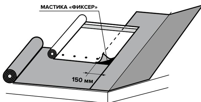
Нахлест АЛЬФА ANDEREP на самоклеящийся подкладочный ковер составляет 150 мм, место перехлеста промазывается тонким слоем битумной мастики ТЕХНОНИКОЛЬ № 23 (Фиксер), толщина нанесения не более 1 мм.
