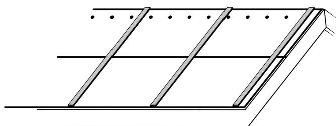
При использовании в качестве временной кровли дополнительно зафиксировать рейками или пятками с шагом 500 см.
